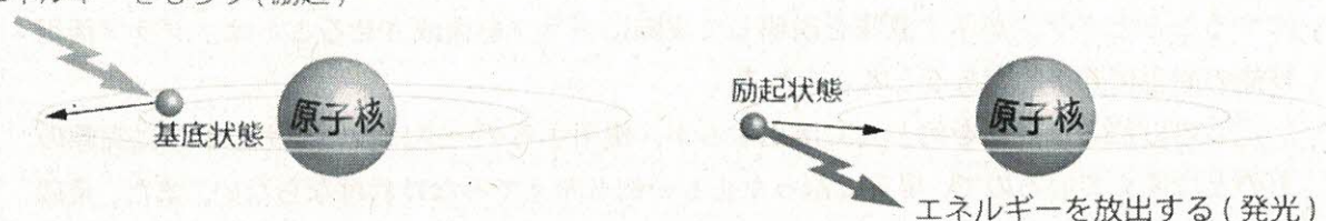
図1 励起エネルギーによる発光
